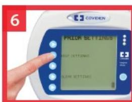
Mettre la pompe sous tension. Sélectionner « Conserver paramètres » pour continuer d'utiliser les réglages précédents ou « Effacer paramètres » pour programmer de nouveaux réglages.
