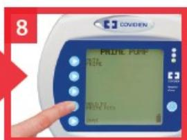
Appuyer sur « Maintenir pour amorcer rinç. » et tenir le bouton enfoncé jusqu'à ce que de l'eau claire circule dans la tubulure. Une fois le rotor en marche, la procédure prend 1 à 2 minutes.
